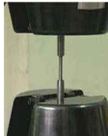
3. Éprouvette installée entre les mors de machine de traction.
