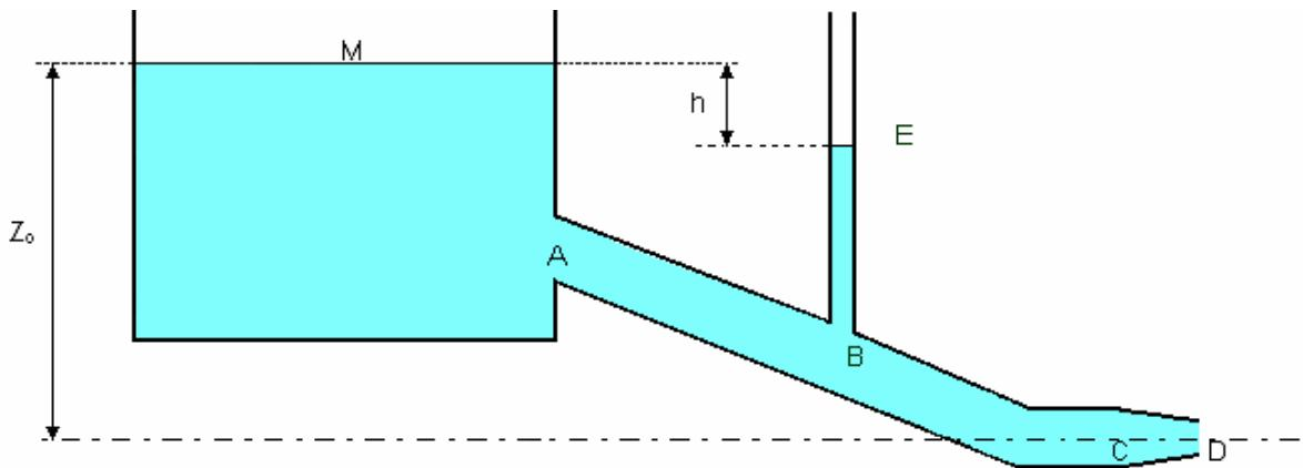
Dans la figure ci-dessus, R est un réservoir rempli d'eau, de très large section et dont le niveau  $Z_0$  est maintenu constant. AC est une conduite de diamètre D. En C se trouve une courte tuyère de diamètre d. C et D sont sur la même horizontale.
