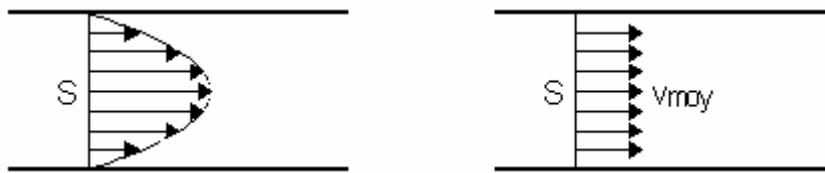
En général la vitesse  $v$  n'est pas constante sur la section  $S$  d'un tube de courant ; on dit qu'il existe un **profil de vitesse** (à cause des forces de frottement).
