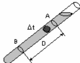
Une bille sphérique tombe lentement dans un tube bien calibré renfermant le liquide visqueux. On mesure la durée  $t$  que met la bille pour parcourir une certaine distance. On montre que la viscosité dynamique  $\eta$  est proportionnelle à la durée  $t$  :
