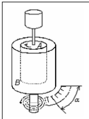
Un cylindre plein (A) tourne à vitesse constante dans un liquide contenu dans un récipient cylindrique (B) ; celui-ci, mobile autour de son axe de révolution, est entraîné par le liquide. Un ressort, exerçant un couple de torsion après avoir tourné d'un angle  $\alpha$ , retient (B) en équilibre.
