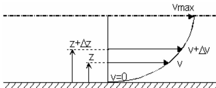
Si on représente par un vecteur, la vitesse de chaque particule située dans une section droite perpendiculaire à l'écoulement d'ensemble, la courbe lieu des extrémités de ces vecteurs représente le profil de vitesse.
