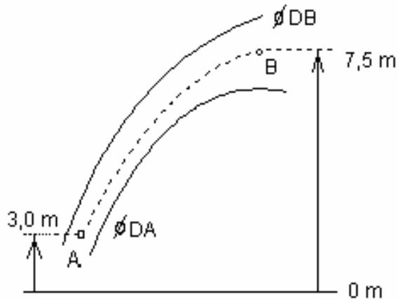
De l'eau (supposé fluide parfait) s'écoule du point A au point B avec un débit-volume de 350 L/s.
