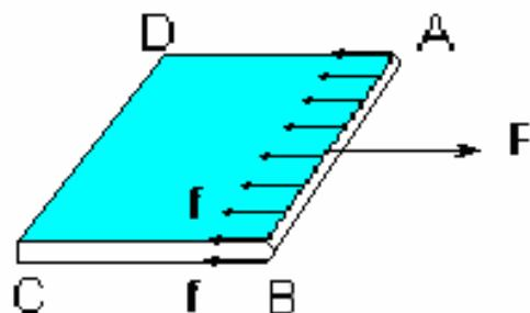
Considérons un cadre ABCD dont le coté AB, de longueur L, peut glisser sur DA et CB. Plongé initialement dans un liquide (par exemple de l'eau de savon), ce cadre est rempli d'une lame mince liquide. Le liquide tire AB vers DC par une force  $f$  sur chaque face de la lame, proportionnelle à la longueur L, telle que  $f = \gamma L$ .
