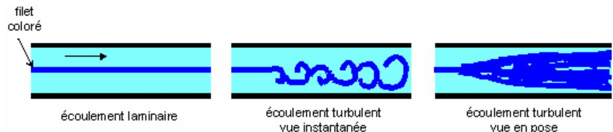
Les expériences réalisées par **Reynolds** (1883) lors de l'écoulement d'un liquide dans une conduite cylindrique rectiligne dans laquelle arrive également un filet de liquide coloré, ont montré l'existence de deux régimes d'écoulement : **laminaire et turbulent**.
