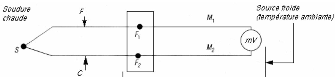
Le couple est constitué par deux fils de fer et de constantan, par exemple, soudés en S; S étant la soudure chaude. La soudure froide étant constituée par les jonctions  $F_1$  et  $F_2$  les fils  $M_1$  et  $M_2$  et le millivoltmètre. Ces procédés de compensation éliminent l'influence de la température de la soudure froide.
