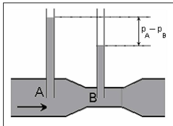
Un conduit de section principale  $S_A$  subit un étranglement en B où sa section est  $S_B$ . La vitesse d'un fluide augmente dans l'étranglement, donc sa pression y diminue :  $v_B > v_A \Rightarrow p_B < p_A$
