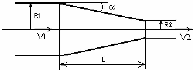
On veut accélérer la circulation d'un fluide parfait dans une conduite de telle sorte que sa vitesse soit multipliée par 4. Pour cela, la conduite comporte un convergent caractérisé par l'angle  $\alpha$  (schéma ci-dessus).
