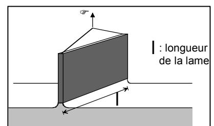
La lame peut être remplacée par un anneau de rayon  $R$ , soutenu par un dynamomètre. On soulève lentement l'anneau et, au moment de son **arrachement** de la surface du liquide, on mesure la force  $F = 4\pi r\gamma$ . On en déduit une valeur de  $\gamma$ .
