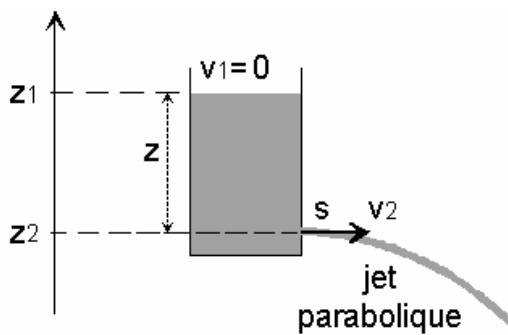
Considérons un réservoir muni d'un petit orifice à sa base, de section  $s$  et une ligne de courant partant de la surface au point (1) et arrivant à l'orifice au point (2). En appliquant le théorème de Bernoulli entre les points (1) et (2),
