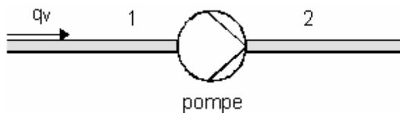
Lorsque le fluide traverse une machine hydraulique, il échange de l'énergie avec cette machine sous forme de travail  $\Delta W$  pendant une durée  $\Delta t$ .
