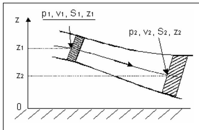
Un **fluide parfait** est un fluide dont l'écoulement se fait **sans frottement**. On considère un écoulement permanent isovolume d'un fluide parfait, entre les sections  $S_1$  et  $S_2$ , entre lesquelles il n'y a aucune machine hydraulique, (pas de pompe, ni de turbine). Soit  $m$  la masse et  $V$  le volume du fluide qui passe à travers la section  $S_1$  entre
