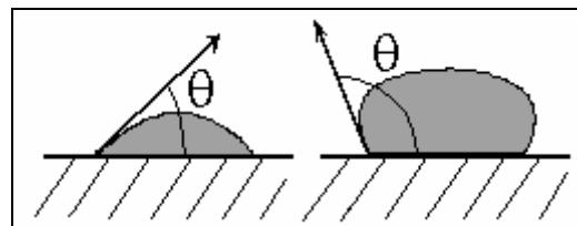
Le même angle de raccordement se retrouve à la surface libre d'un liquide près des bords du récipient et provoque la formation d'un ménisque dans les tubes.
